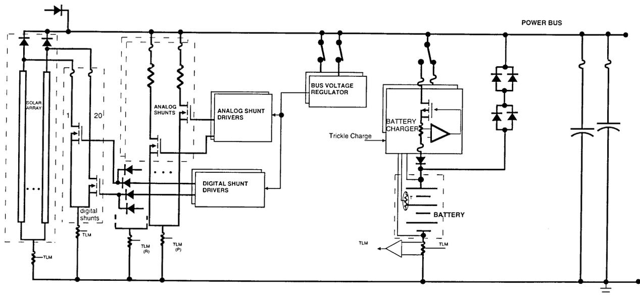
**Fig. 9. Power System Block Diagram**
