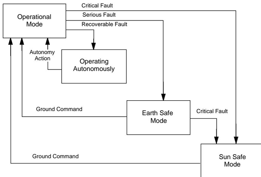
**Fig. 14. Mode Transition State Diagram**
