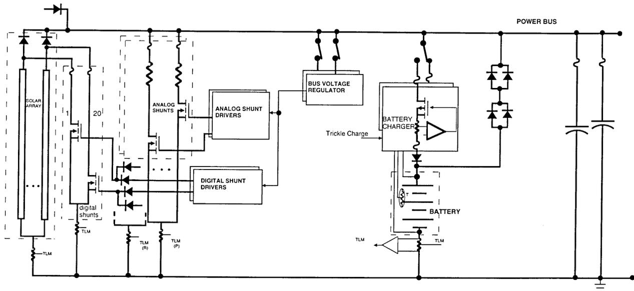
**Fig. 9. Power System Block Diagram**
